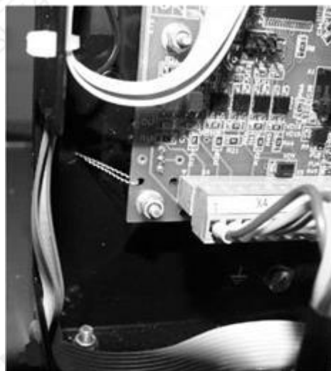
Рисунок п4.2 Пломбировка генератора импульсов
