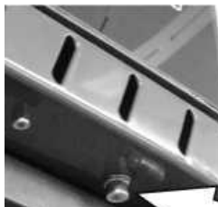
Рисунок 1.2 – Крепление откидного кожуха
