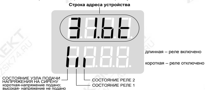
Рисунок 10 – Пример табло показывающего прибора при просмотре состояний реле БПК
