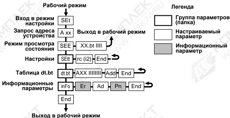
Рисунок 8 – Структура меню реле БПК при настройке с помощью показывающих и сигнализирующих приборов (например, МС-К-500-...)
