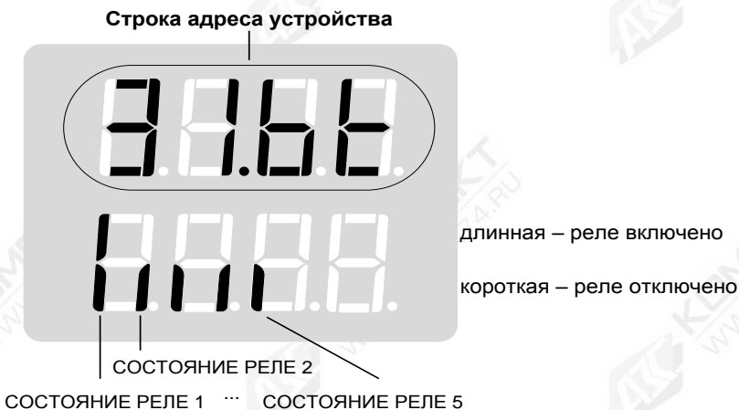
Рисунок 9 – Пример табло показывающего прибора при просмотре состояний реле БПК
