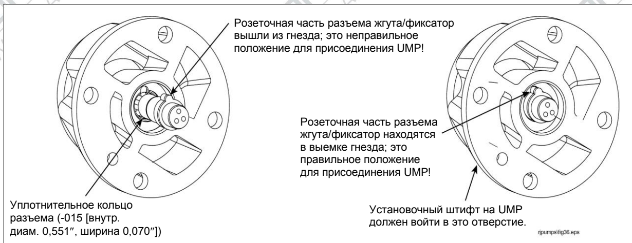
Рисунок 6. Проверка правильности положения розеточной части разъема жгута
