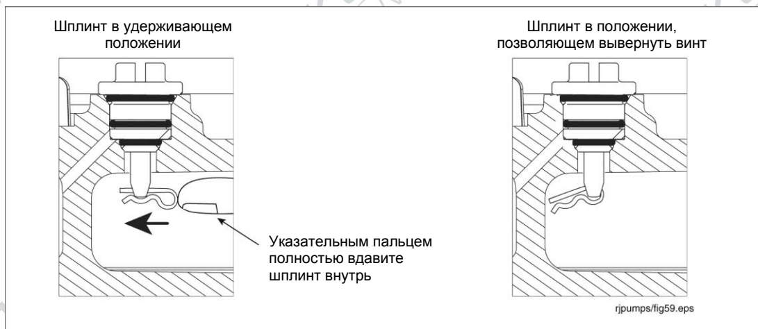
Рисунок 40. Изменение положения шплинта винта воздушной продувки
