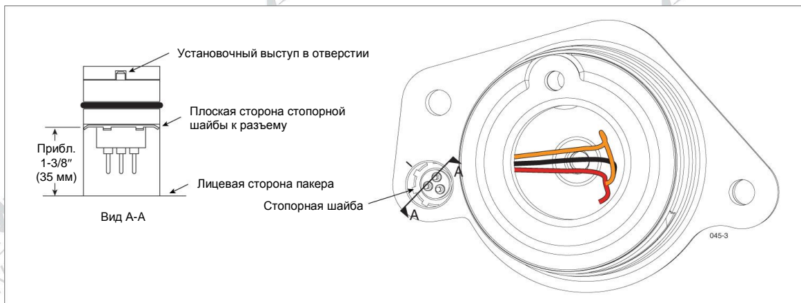
Рисунок 36. Правильная глубина посадки вилки разъема в гнездо пакера
