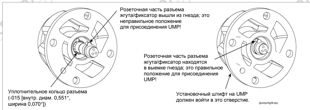
Рисунок 28. Проверка правильности положения розетки разъема жгута
