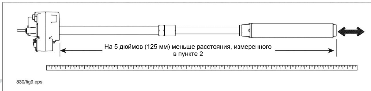
Рисунок 10. Регулировка длины насоса
